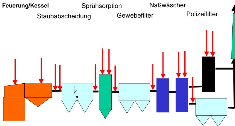
Primärseitige Maßnahmen beziehen sich auf den Bereich der Feuerung und Verbrennung bis zum Kessel, wobei hier das Quecksilber bzw. dessen Verbindungen in eine für die nachfolgende Abscheidetechnologie notwendige Form umgewandelt werden muss. Dabei sind im wesentlichen die Reaktionen mit dem Rauchgasbestandteil HCl ( $\text{Cl}_2$ ) von Bedeutung. [4]
